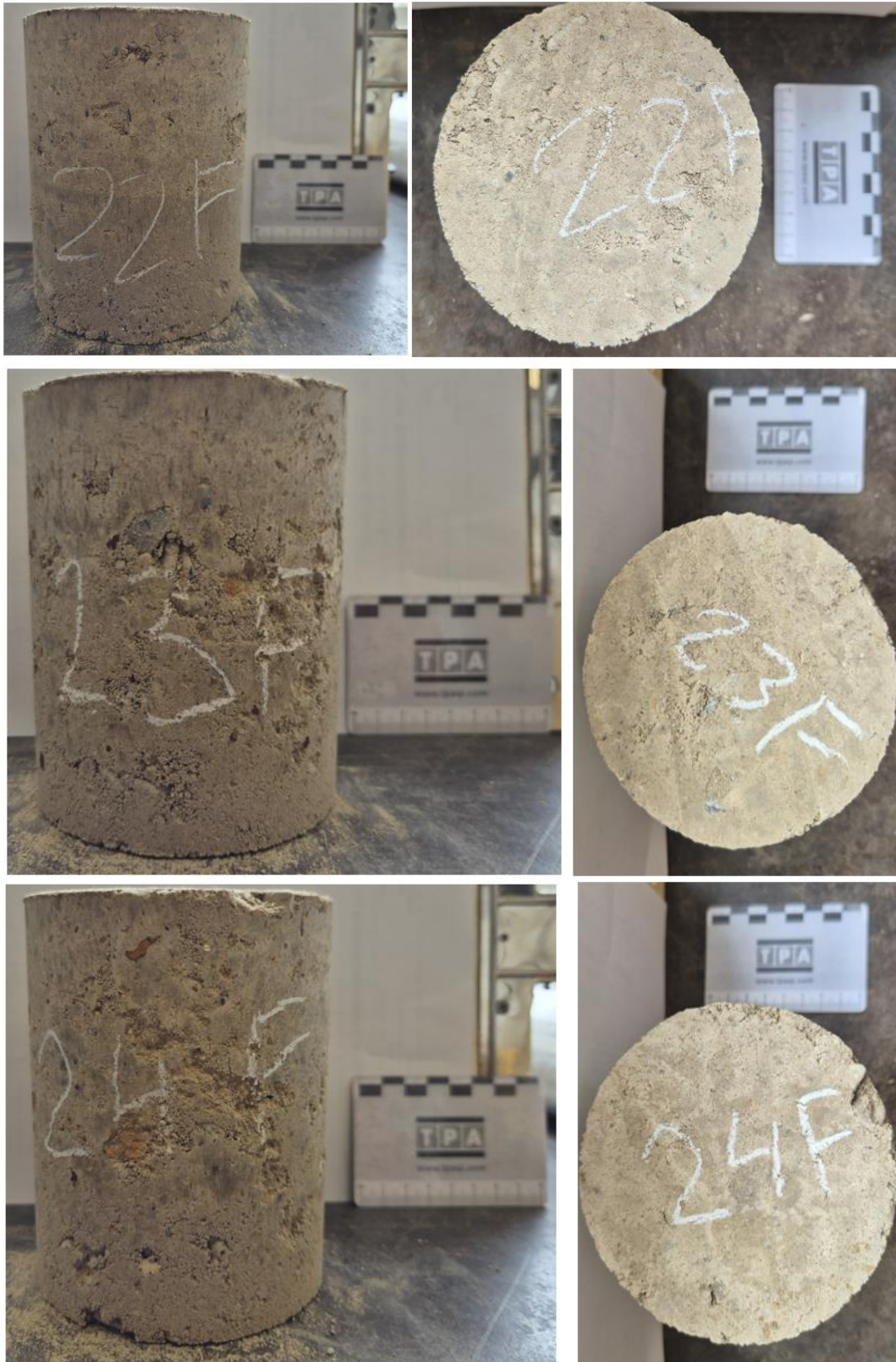
Abbildung 7: Boden + 9 M.-% CEM II 32,4 H + Terrasolid; (Probe 22F bis 24F)
