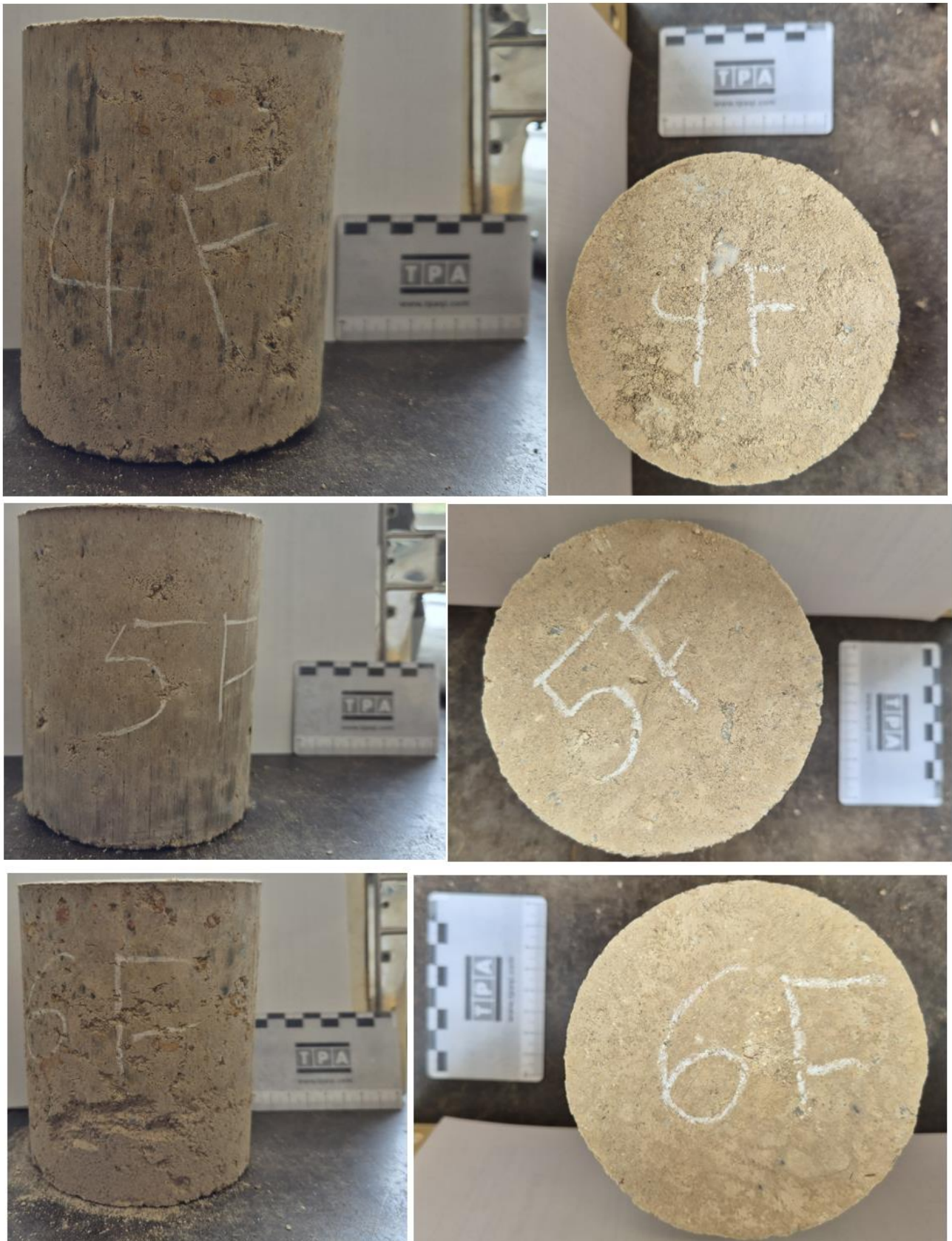
Abbildung 4: Boden + 3 M.-% CEM II 32,5 H + Terrasolid; (Probe 4F bis 6F)
