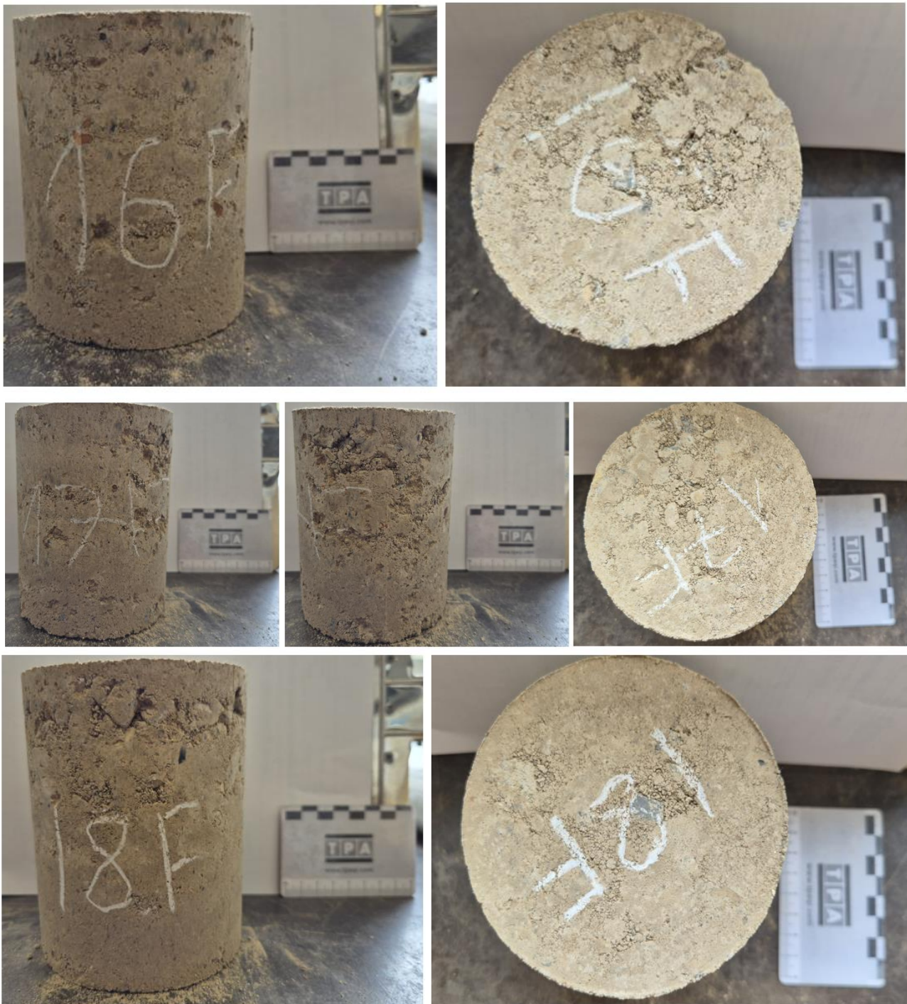
Abbildung 6: Boden + 7 M.-% CEM II 32,4 H + Terrasolid; (Probe 16F bis 18F)
