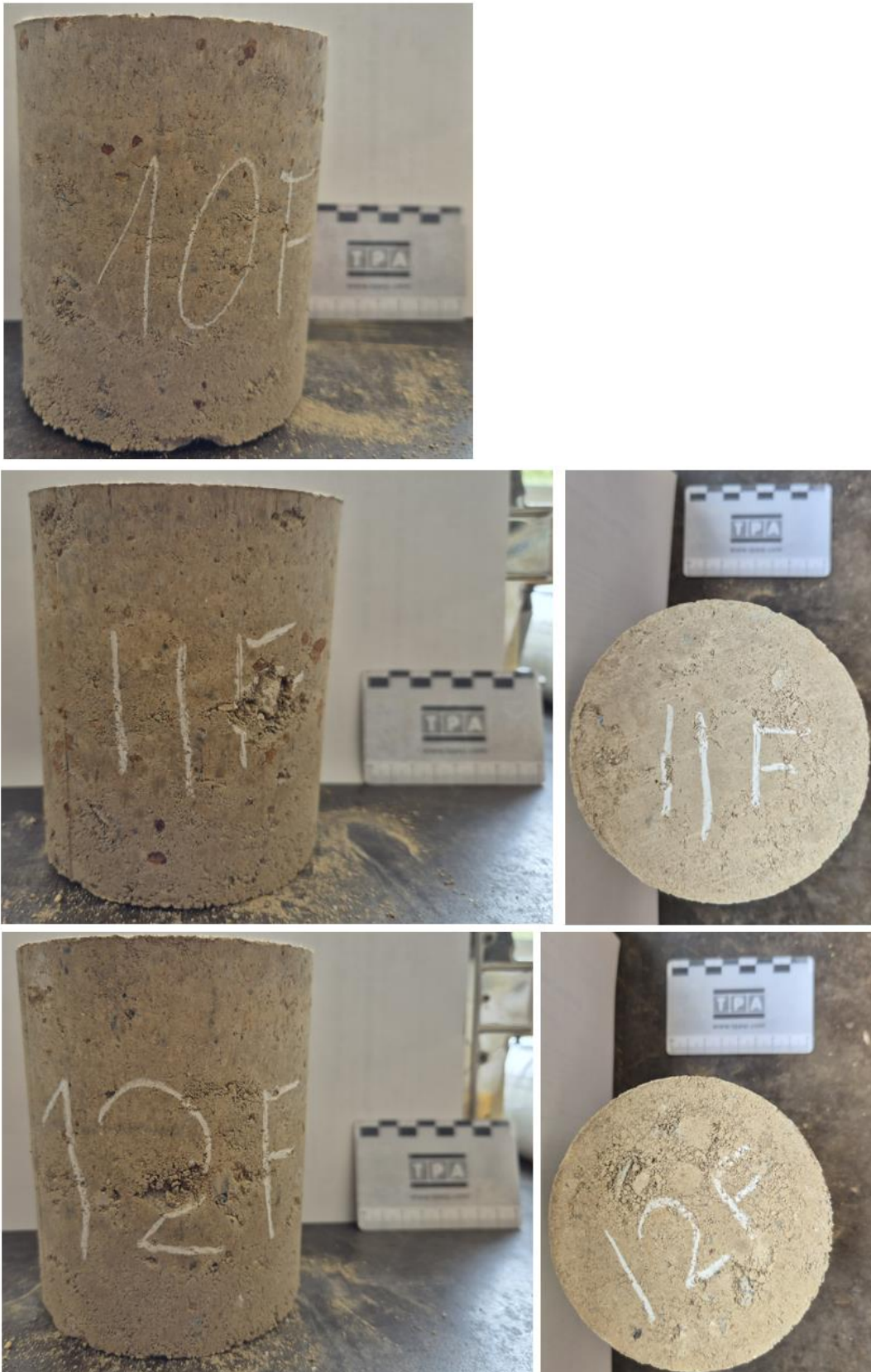
Abbildung 5: Boden + 5 M.-% CEM II 32,5 H + Terrasolid; (Probe 10F bis 12F)
